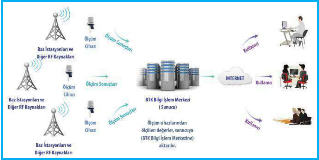
Şekil 48: Elektromanyetik Alanları Sürekli İzleme Sisteminin İşleyişi
