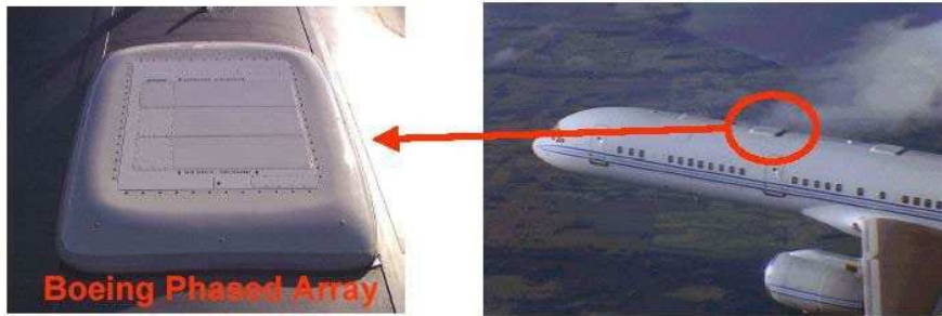
Resim - 1: Boeing tarafından kullanılan Ku-band düz antenler
